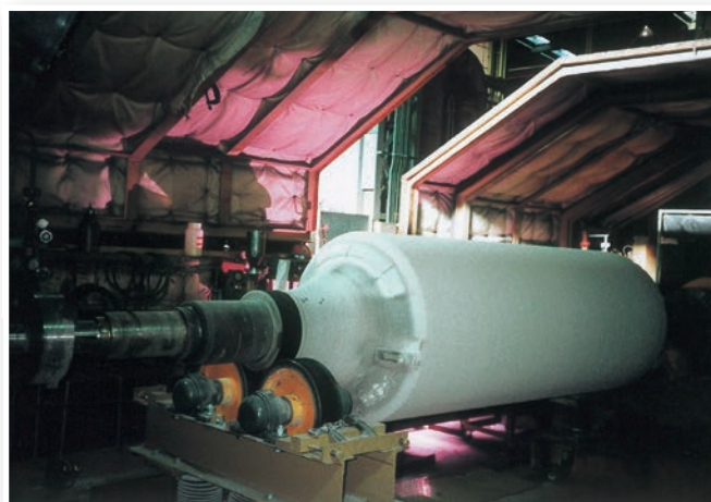
製鋼所の圧延ラインに使用される、ハースロールの表面改質にアルミナのプラズマ加工する設備を納入し、 集塵機・防音プラントと自動化設備が注目された。
