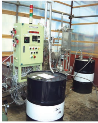
真空蒸留連続回収装置CA900シリーズは、国内外問わず、海外での納入実績も年々増加。また、第一石油類・第二石油類の蒸留に対応。
